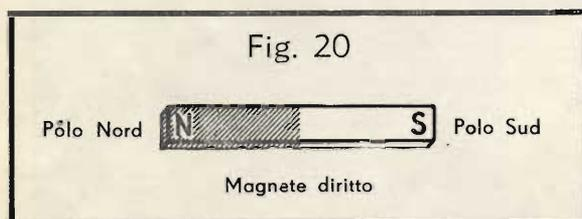
Oltre alle *calamite a ferro di cavallo*, che voi conoscete, esistono anche delle *calamite diritte* (fig. 20); queste si possono pensare formate raddrizzando una calamita a ferro di cavallo (fig. 21). La forza di attrazione delle due estremità di un magnete diritto è la stessa. Le due estremità si chiamano poli del magnete. Uno dei poli si chiama polo nord e l'altro polo sud.
