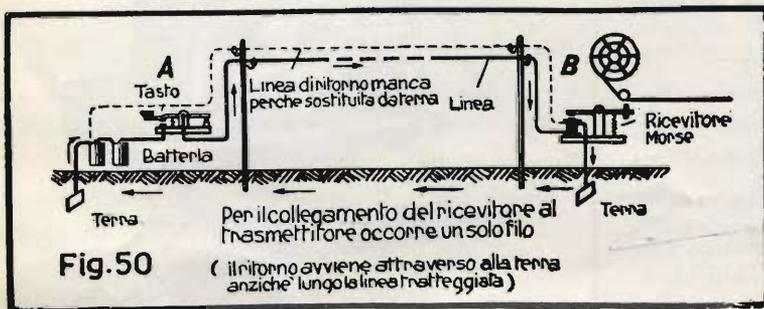
Come vedete in questo caso si utilizzano tutti e tre i morsetti del trasmettitore Morse. Seguite nuovamente il circuito, nel caso che venga trasmesso da A come pure se viene trasmesso da B.
