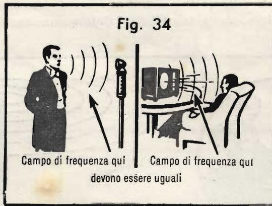
medesima estensione e con la stessa distribuzione di intensità sonora, la gamma delle frequenze impresse al microfono, si potrà parlare di «riproduzione fedele».
