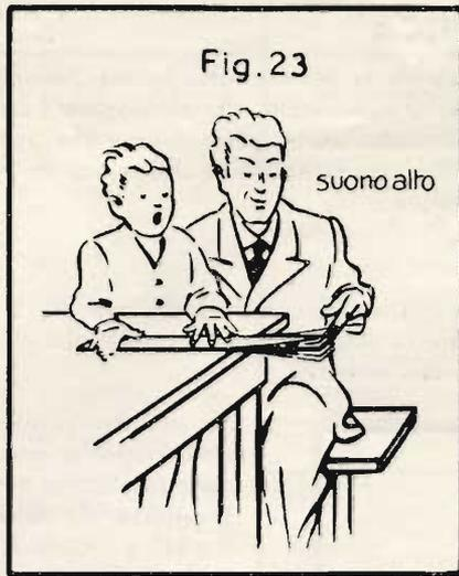
Più lunga è la parte vibrante dell'asticciola, e più lente sono le vibrazioni e basso il suono (fig. 22). Un'asta corta vibra più rapidamente; essa genera vibrazioni dell'aria più rapide e quindi suoni più alti (fig. 23).
